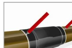
3.2. Прогреть подготовленные поверхности оболочек с обеих сторон от стыка мягким пламенем пропановой горелки до температуры не менее  $40^{\circ}\text{C}$  пройдя «точку росы». На прогретую поверхность оболочек по периметру наклеить адгезивную ленту (по рискам).
