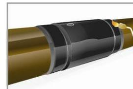
3.7. Для муфт, диаметром 400 мм и более, сразу после окончания усадки, не допуская снижения температуры на краях муфты ниже  $110^{\circ}\text{C}$ , стянуть края муфты бандажными ремнями, шириной не менее 50 мм. Ремни снимать после остывания муфты и П/Э оболочки до  $+40^{\circ}\text{C}$ .
