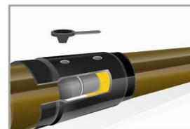
4.6. Дать остыть заваренным пробкам до температуры +40°C. Срезать выступающие края П/Э пробки резакром (напильником). Зачистить место вокруг заваренных пробок на расстоянии 50 мм наждачной бумагой и обезжирить. Прогреть адгезивный слой на П/Э заплатках и установить их на места заваренных пробок. Прогреть пламенем горелки и прикатать роликом (разгладить термостойкой перчаткой).
