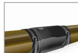
3.8. Контроль герметичности производится опрессовкой после остывания муфты до температуры  $+40^{\circ}\text{C}$ . В отверстие, просверленное по п.3.5., вставляется специальное устройство для опрессовки, через него в муфту накачивается воздух под давлением 0,05 МПа. Муфта выдерживается под испытательным давлением в течение 5 минут.
