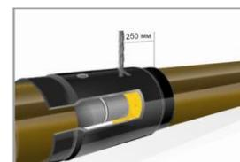
4.2. Теплоизоляцию стыка производить с помощью пенопакета, заливочной машины или другим способом, обеспечивающим качественное смешение компонентов ППУ согласно инструкции предприятия-изготовителя.
