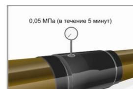
3.9. В случае падения давления по периметрам стыков муфты-оболочки при помощи опрыскивателя наносится мыльный раствор. Дефектные места определяются по пузырькам мыльного раствора. При обнаружении дефектных мест повторно прогреть их мягким пламенем пропановой горелки и повторить испытания. При удовлетворительном результате испытания из отверстия извлекают устройство для опрессовки.
