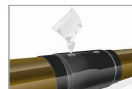
4.3. Через отверстие залить в полость стыка смесь компонентов ППУ. Закрывать отверстия дренажными пробками. В процессе вспенивания незначительное количество пены вытечет через дренажные отверстия пробок. Это свидетельствует о полном заполнении объема стыка.
