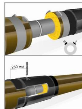
3.5. Муфту отцентровать при помощи центраторов, добиваясь равного расстояния между ПЭ оболочкой и муфтой по верхнему и нижнему срезу. На расстоянии 250 мм от торца муфты сверху просверлить отверстие  $D = 25$  мм.
